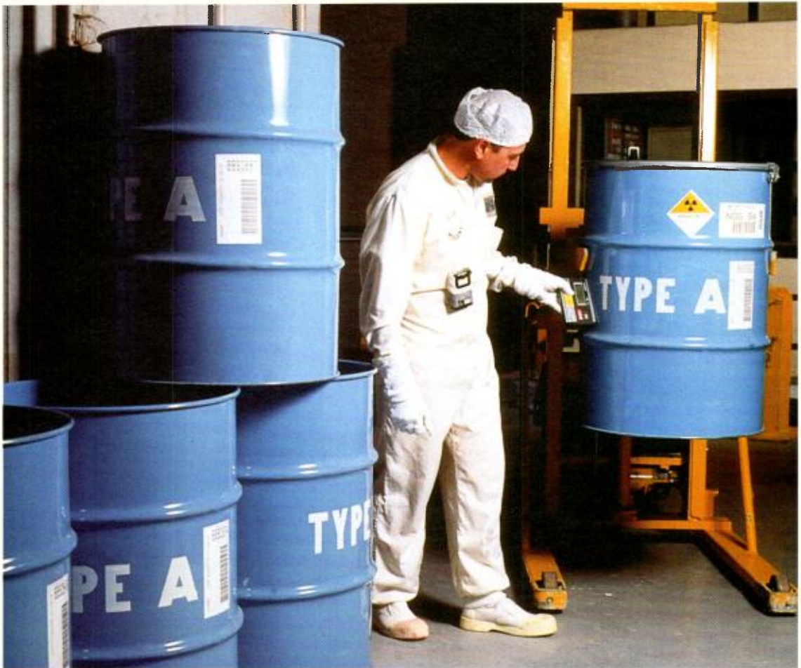
A Nogent-sur-Seine, dans le bâtiment réservé au traitement des effluents, contrôle de la radioactivité de fûts de stockage contenant des déchets militaires.
