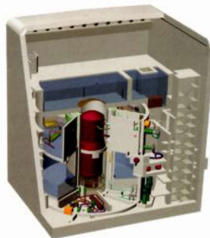
Figure 1 - Planche montrant une vue éclatée du SWR 1000
